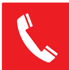
TELEFONO PER INTERVENTI ANTINCENDIO
