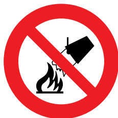
VIETATO SPEGNERE CON ACQUA
